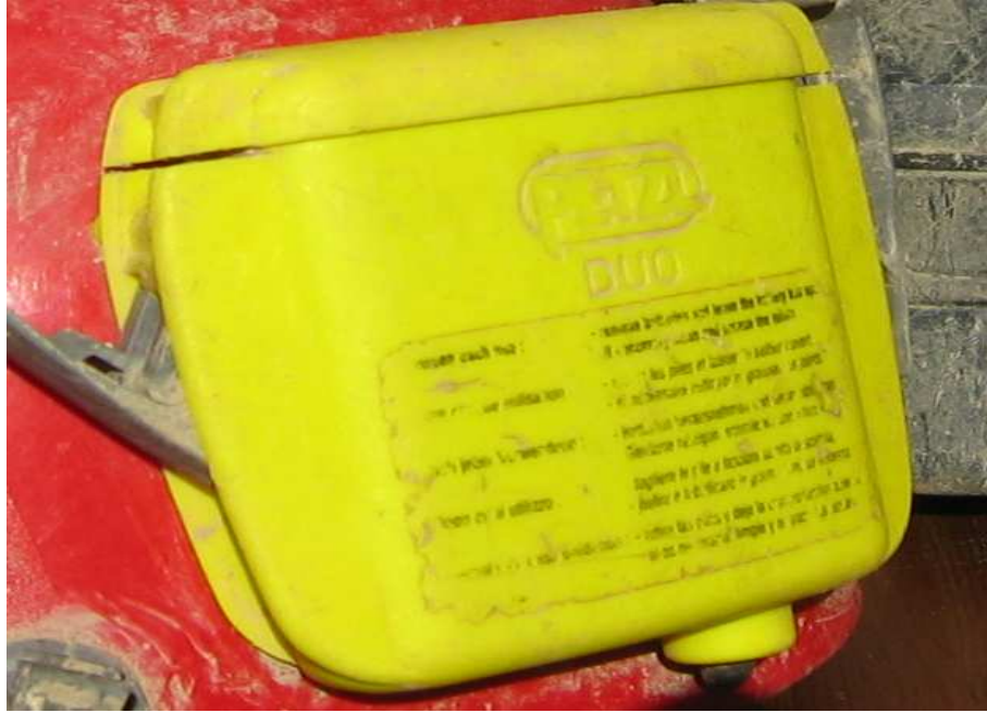
En aquest recipient s'allotgen les piles amb les quals s'alimenten les dues bombetes
