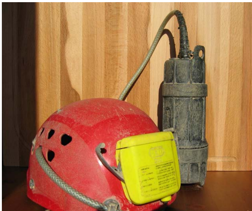
Vista general del casc amb el contenidor de les piles
