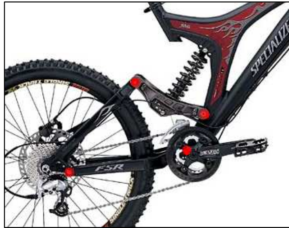
Imatge explicativa realitzada per l'autor del treball Els quatre punts de pivot d'un sistema multipivot.
