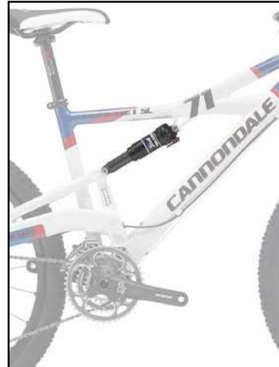
L'amortidor va situat al centre de la bici. Imatge explicativa realitzada per l'autor del treball.
