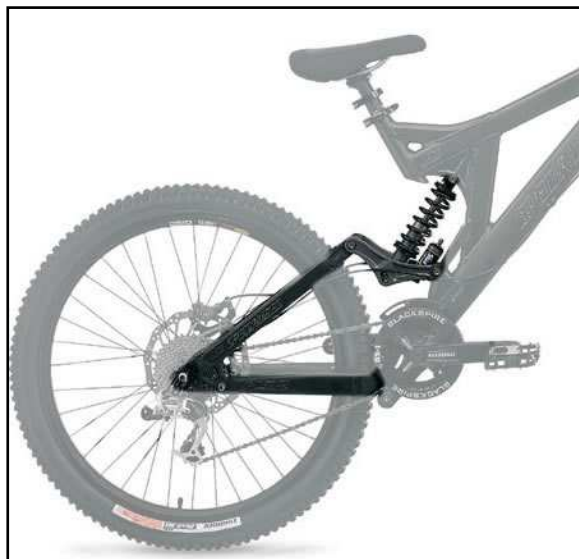
Parts del sistema de suspensió: basculant i amortidor. Imatge explicativa realitzada per l'autor del treball.
