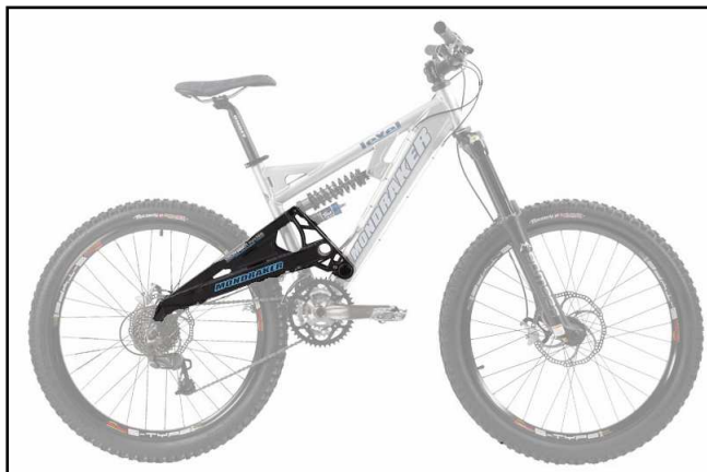
Basculant: part del sistema de suspensió. Imatges explicatives realitzades per l'autor del treball.
