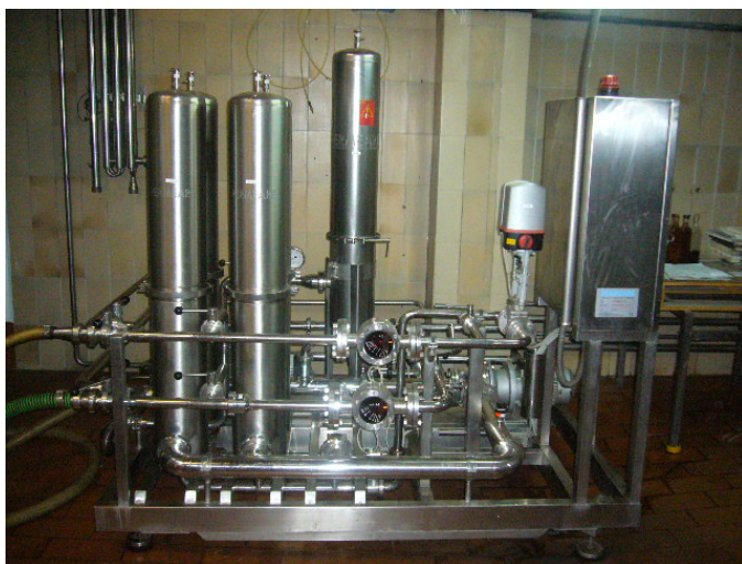
Màquina de filtració tangencial. 6 d'agost de 2009, Vinagres Badia, Mollerussa.
