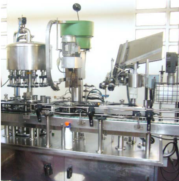
Envasadora automàtica en ampolles de vidre. 6 d'agost de 2009, Vinagres Badia, Mollerussa.
