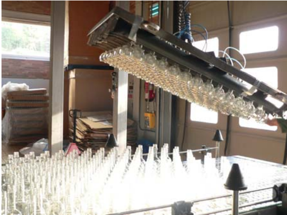
Màquina de pressió que recull i col·loca les ampolles a la cinta transportadora. 29 de setembre de 2009, Vinagrieres del Penedès, Pacs del Penedès.
