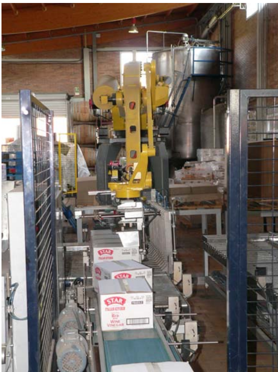
Robot a punt de col·locar les caixes en un palet. 29 de setembre de 2009, Vinagrerries del Penedès, Pacs del Penedès.
