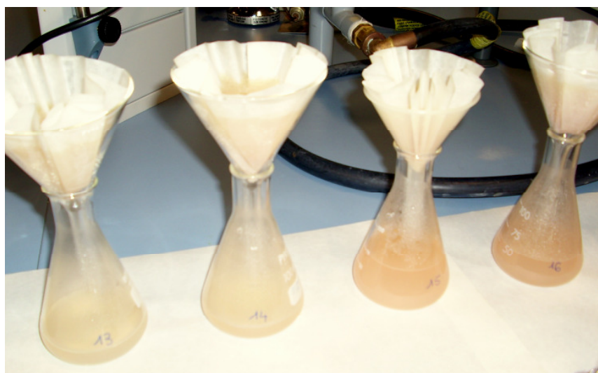
Figura 7. Filtració de les solucions de fuet una vegada s'han extret els nitrits
