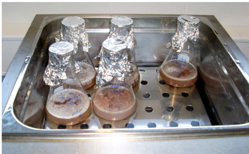
Figura 6. Extracció de nitrits de mostres de fuets en un bany d'aigua
