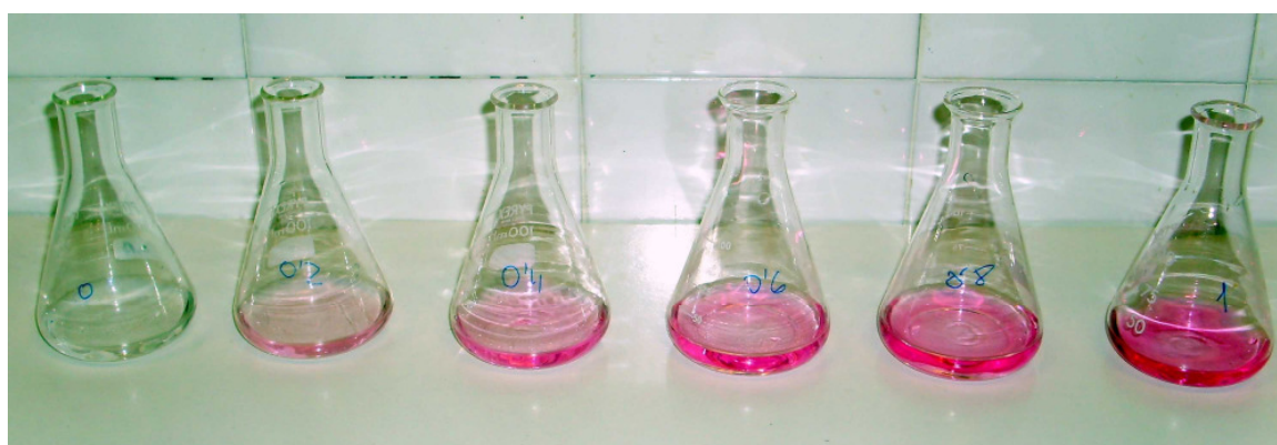
Figura 4. Corba patró preparada per a la determinació de nitrats (0-1 ppm, amb increments de 0,2 ppm) utilitzant \text{NaNO}_2
