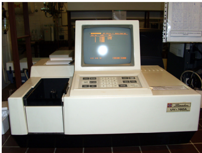
Figura 5. Lectura espectrofotomètrica durant la realització de la corba patró per a la determinació de nitrats en productes carnis
