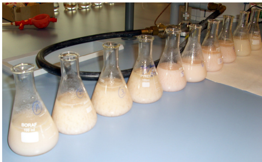
Figura 8. Defecació dels extractes de les diferents mostres
