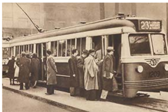
Tramvia 1209 carregant viatgers per la porta davantera. Inicialment els tramvies carregaven els viatgers per darrere, on se situava el cobrador.
