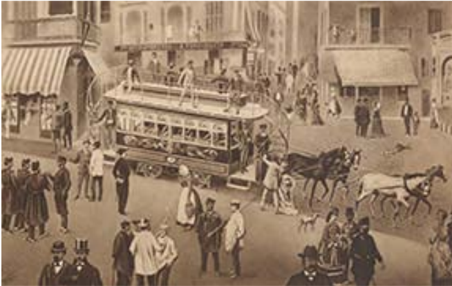
Imatge d'un dels primers tramvies instal·lats a Barcelona, amb tracció a sang i imperial (doble pis). Foto feta a Rambles - Pla de la Boqueria.
