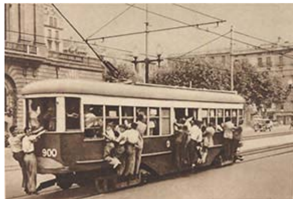
Tramvia sèrie 900 de via estreta circulant sobre una línia de doble amplada en estoig prop del Pla de Palau. El tramvia 900 estrenà el pis baix en l' accés, a tan sols uns centímetres del sòl, en l'any 1923.
