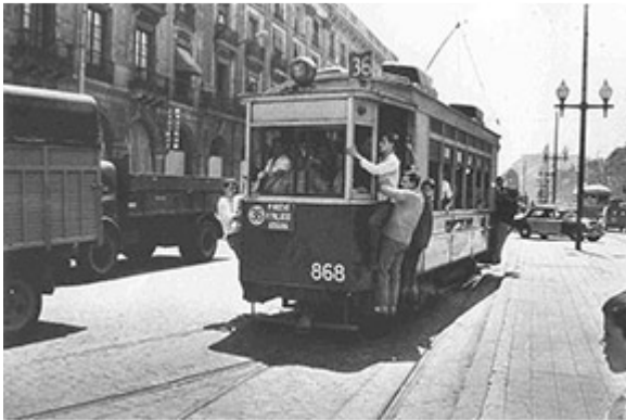
Tramvia d'ample internacional construït el 1924 i convertit en unidireccional a partir de 1945. Durant la postguerra per falta de material mòbil, i durant el "boom" econòmic per excés de demanda, els tramvies pateixen un col·lapse important i sobrecàrrega.
