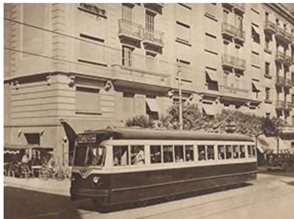
Un dels canvis que la nova política de l'empresa va introduir en els 50, fou la progressiva unidireccionalitat dels tramvies en totes les línies. En la foto, tramvia 1200, amb portes només a la dreta
