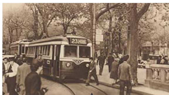
Amb la unidireccionalitat i la càrrega només per un costat, van aparèixer nous problemes, com les dificultats per efectuar parada en zones amb un passeig central
