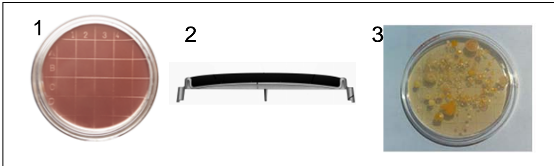
Figura 1.18. Mostreig de superfícies amb les plaques RODAC on s'observa les divisions que hi ha a la part inferior per facilitar el recompte (1), detall del menisc que forma el medi en la placa de cultiu que permet que aquest es posi en contacte amb la superfície a mostrejar (2) i plaques després de la incubació (3 i 4)
