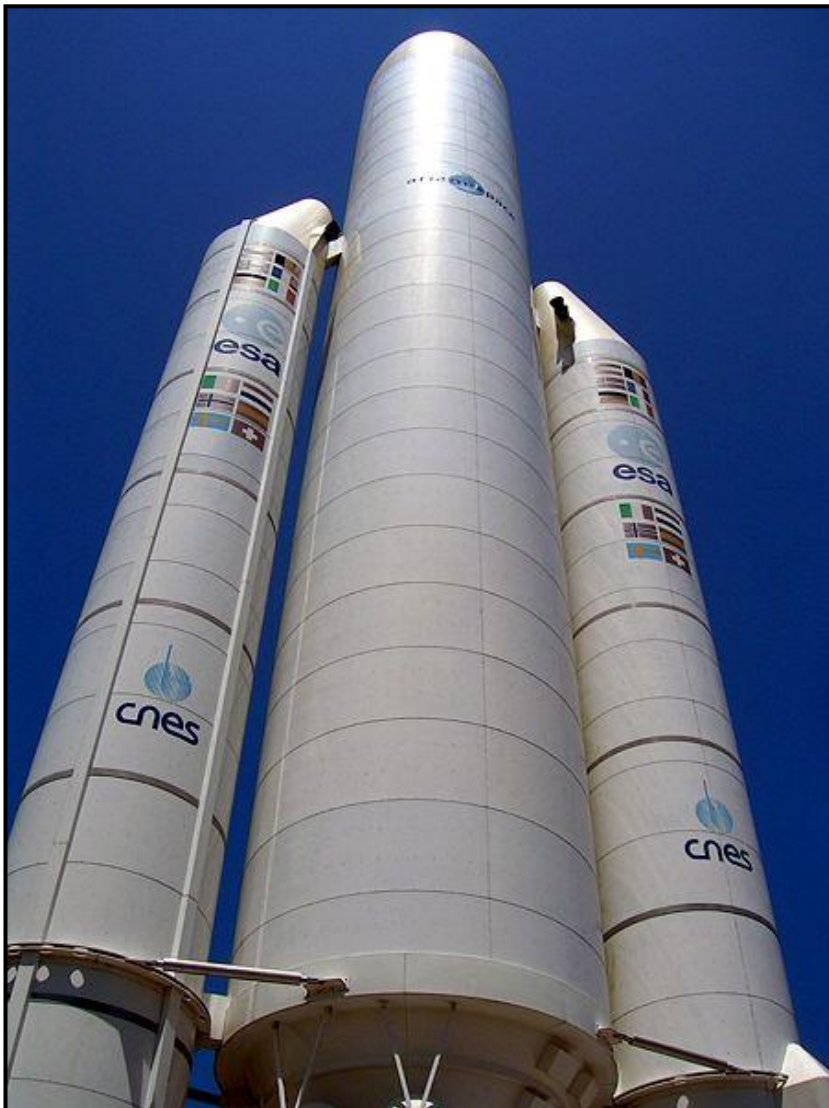
Maqueta de l'Ariane 5 (ESA). Aquesta aeronau funciona amb oxigen i hidrogen líquid.
