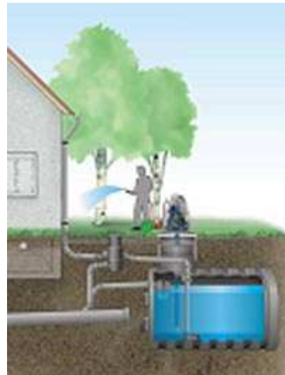
Imatge 21: Sistema de recollida de l'aigua pluvial
