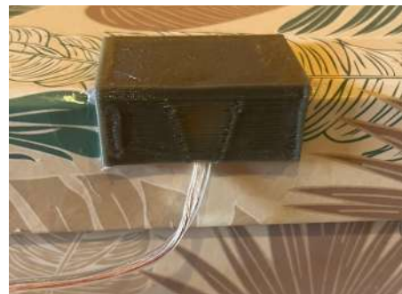
Fig. 51 Peça impresa 3D que tapa el forat.
