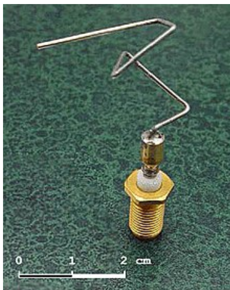
Figura 12: L'antena del vehicle espacial ST5 de la NASA del 2006. La complicada forma va ser trobada per un programa de disseny evolutiu per crear el millor patró de radiació.
