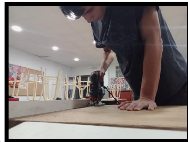
Figura 9. Tall de la base per fer les mides òptimes. Font. Elaboració pròpia
