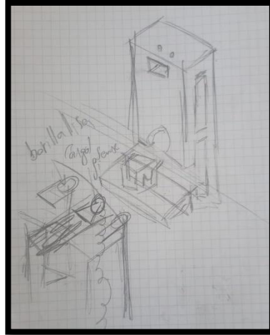
Figura 6. Esbós carril CNC eix Y. Font. Elaboració pròpia
