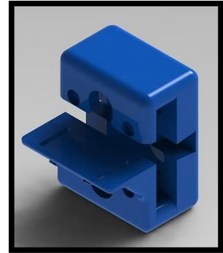
Figura 19. Render Carril CNC eix X v3. Font. Elaboració pròpia.
