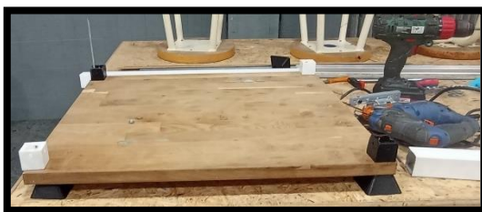
Figura 10. Base amb els 4 subjecta perfils i les 4 potes. Font. Elaboració pròpia
