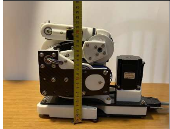
Fig. 49: Dimensions del braç robòtic
