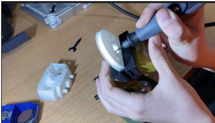
Fig. 34: Modificació d'una peça amb la Dremel 3000
