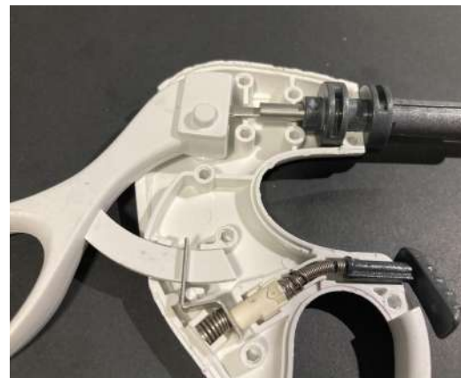
Fig. 27: Funcionament pinça de laparoscòpia
