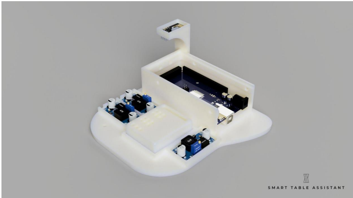
IMATGE 25. CAIXA CONTROL SERVOMOTORS (PRÒPIA)
