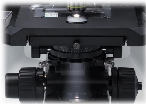
Imatges 22 i 23: El microscopi Olympus BX43 (fotografia superior), juntament amb una fotografia del mecanisme de graduació manual (inferior). Font: Servei d'Anatomia Patològica de l'Hospital de Palamós.
