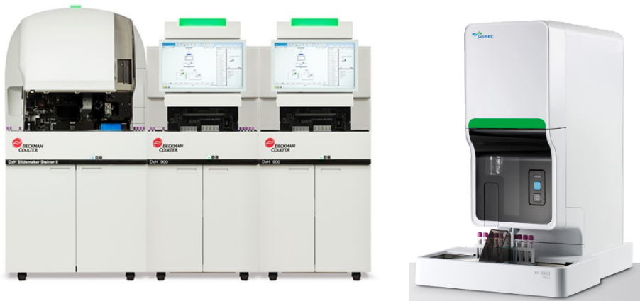
Figura 4: analitzadors de quarta generació, disponibles en cadena de forma robotitzada i amb programes de gestió de les dades.
