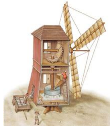
Molí el qual fa servir la força del vent per moldre el gra
