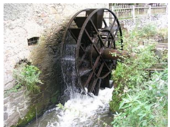
Roda hidràulica la qual aprofita l'energia de l'aigua del riu per crear un moviment de rotació
