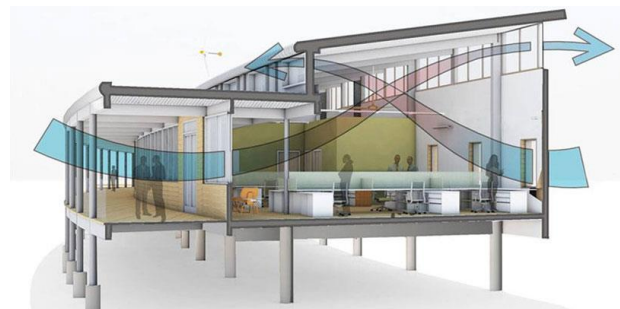
Funcionament de la ventilació creuada automàtica
