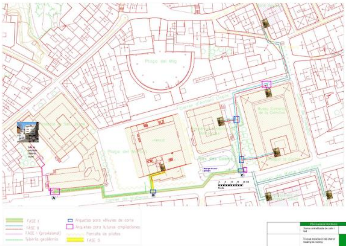
Plànol dels 2 circuits de canonades aplicats a la Xarxa
