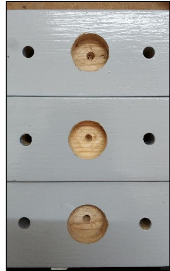
Figura 23. Peces 1 i 2 on es veu la paret interior per recolzar el rodament
