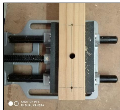
Figura 24. Peces 3 i 4 sense pintar i on es veuen les marques per perforar.
