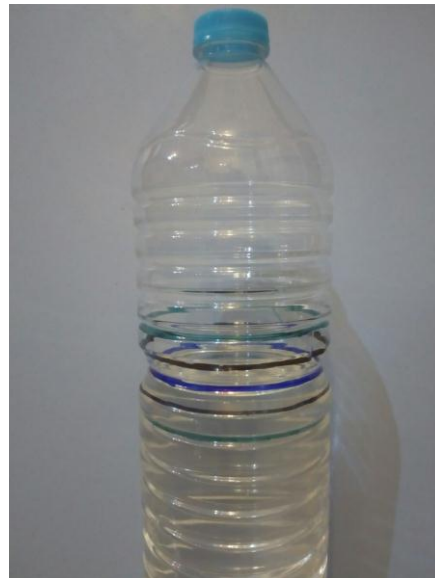
Figura XXIX. Nivell per a marcar l'escora del Laser fet amb una ampolla que es lliga al màstil amb un sandow. El nivell 1 correspon al color blau, el nivell 2 al color negre i el nivell 3 al color verd.
