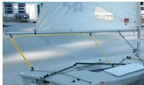
Figura 35. Sistema de l'escota marcat de color groc.
