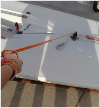
Figura XIX. Anna Masmartí muntant el final del sistema del pujament: un nus de cadena que acaba en forma de baga per poder manipular el trimatge.
