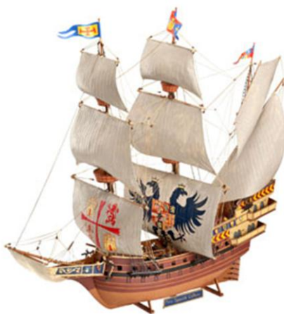
Figura 11. Rèplica d'un galió espanyol. Presenta una vela civadera al bauprès, tres veles quadrades al trinquet, tres veles quadrades al pal major i, una vela llatina i una vela àurica al pal de messana.
