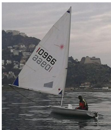
Figura 38. Navegació forçant amura amb la vela oberta més de 90° i l'orsa lleugerament aixecada.
