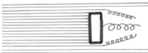
Figura 18. Turbulències al buit degudes a la interrupció del moviment de les línies de corrent en topar amb un obstacle no aerodinàmic.
