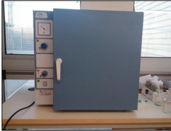
Fotografia 15: Estufa proporcionada per l'IES Vallvera, amb la qual hem mantingut les mosques en escalfor, a 25°.
