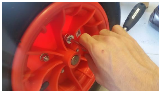
Figura 55 – Fixació dels cargols de les rodes
