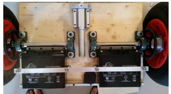
Figura 51 – Fixació de les bateries
