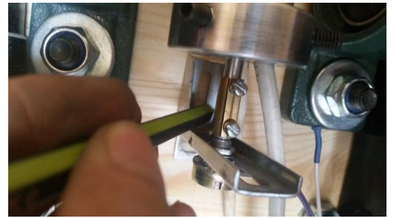
Figura 59 – Fixació del potenciòmetre
