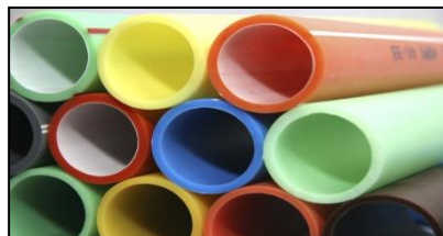
Imatge 2.4 Producte obtingut per extrusió
