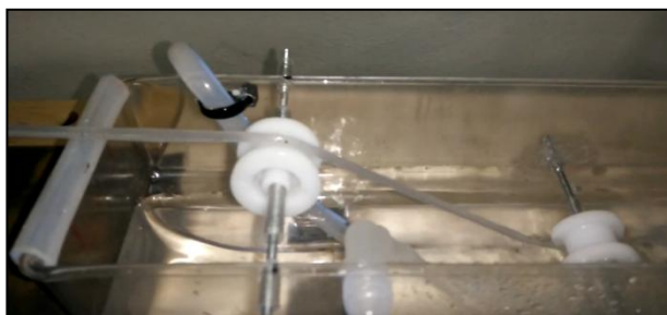
Imatge 8.6 Politges de la piscina de refrigeració
