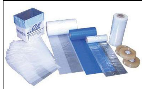
Imatge 2.14 Productes obtinguts per calandratge
