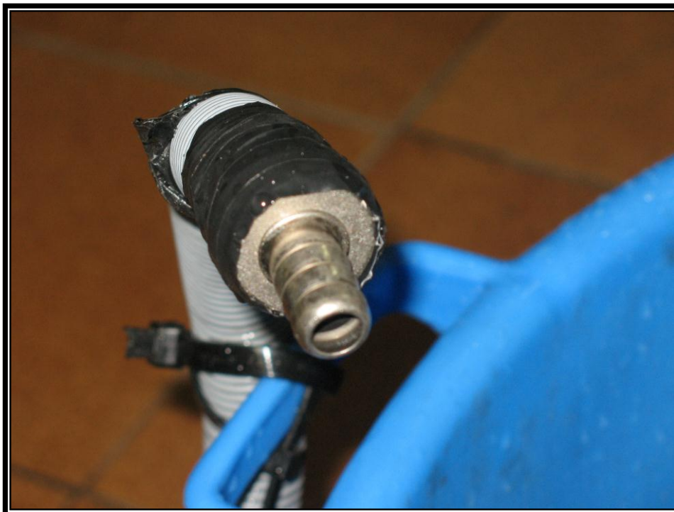
Fotografia de l'extrem del tub. Si poden observar els reductors de diàmetres corresponents per tal d'aconseguir una pressió hidràulica superior a la sortida.
