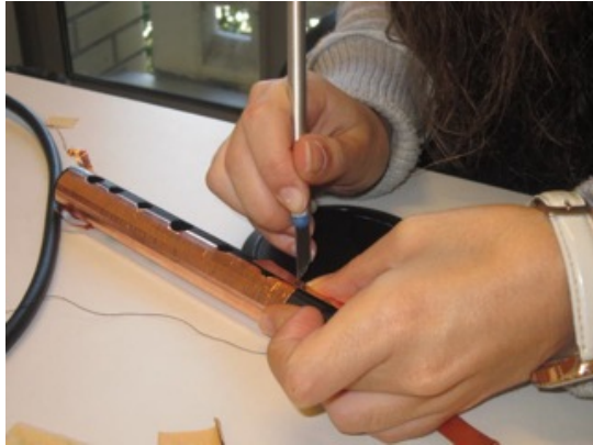
Tallant a mida amb un cúter la cinta de coure
