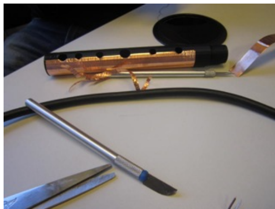
Recobrint del flabiol amb la cinta de coure
