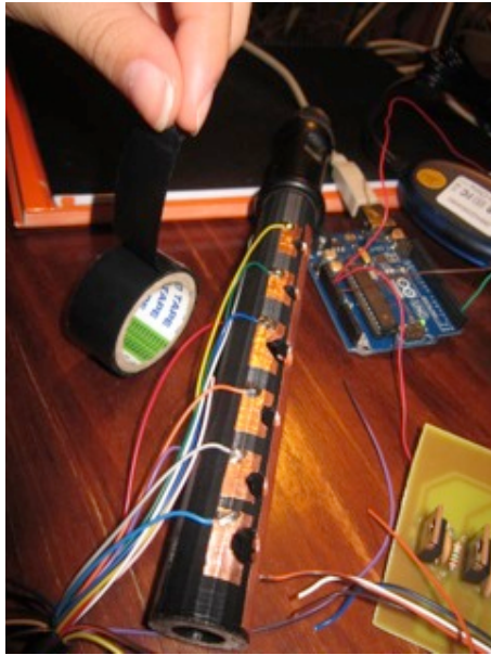
Tapem amb cinta adhesiva negra els cables
