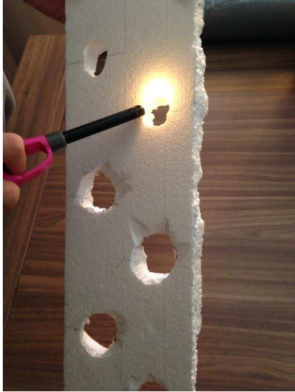
Fig. D.1. Realització dels forats en el porexpan.
