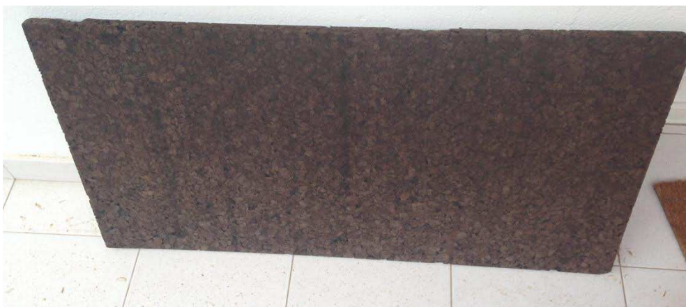
Fig. 5.1.4. Planxa de suro aglomerat negre. (Font pròpia)
