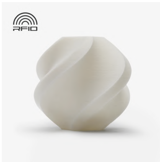
Figura 25: Imatge d'una impressió feta amb PLA (Àcid Polilàctic). Font: [29]
