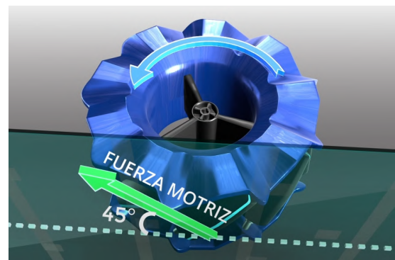
Figura 22: Força motriu d'una roda Mecanum. Font: [11]
