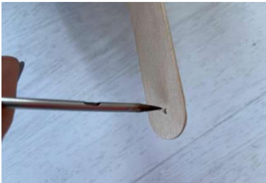
Figura 61: Fent forats als pals de fusta per poder muntar l'elevador de tisores. (FONT. Elaboració pròpia.)
