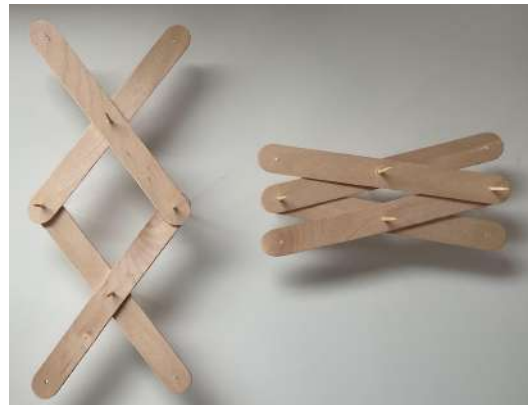
Figura 62: Elevador de tisores muntat per aquesta caixa (FONT. Elaboració pròpia.)
