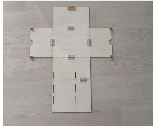
Figura 60: Caixa desplegada després de posar cinta adhesiva sobre les xarneres per assegurar que no es trenquin. (FONT. Elaboració pròpia.)
