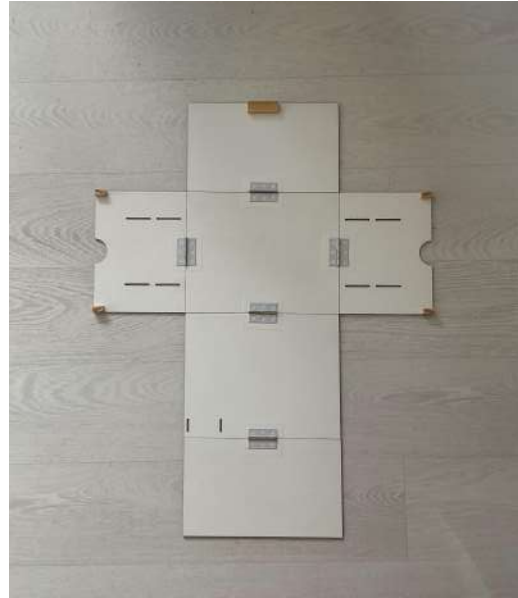
Figura 79: Caixa desplegada després de posar cinta adhesiva sobre les xarneres per assegurar que no es trenquin. (FONT. Elaboració pròpia.)
