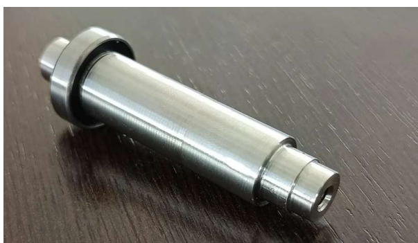
Figura 2. Eix de recolzament amb rodament.
