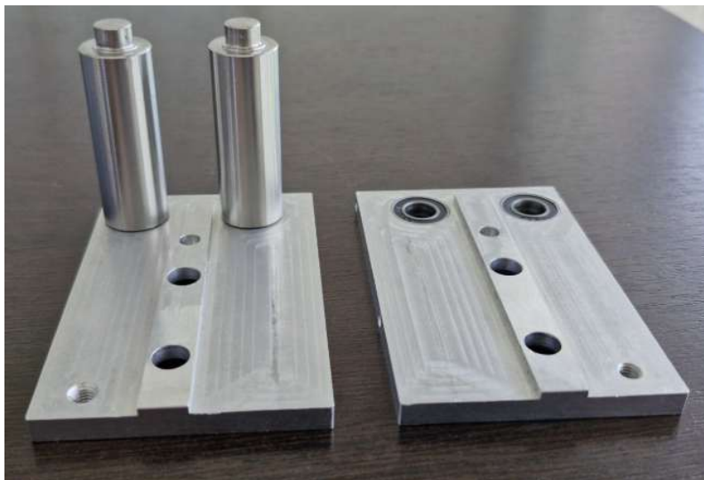
Figura 32. Placa lateral amb els conjunts laterals.
