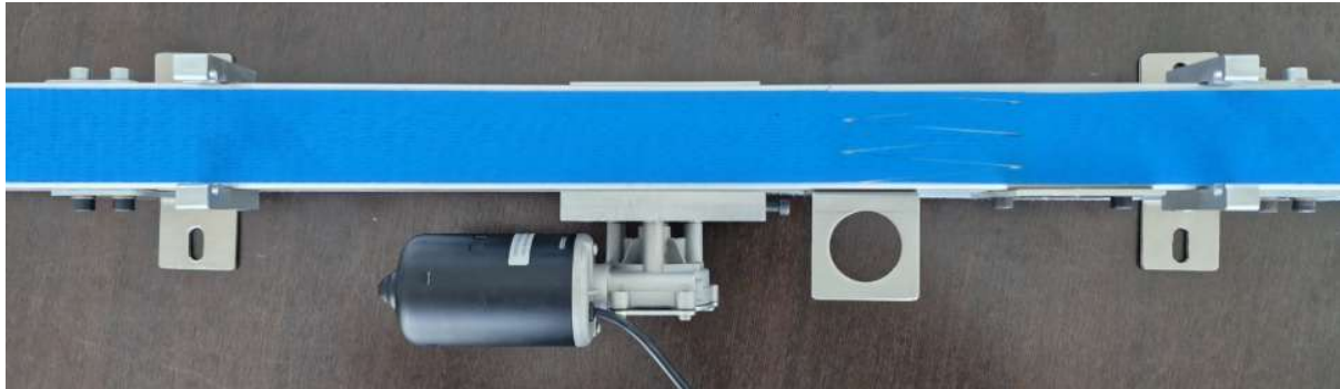
Figura 24. Col·locació dels suports de la cinta.
