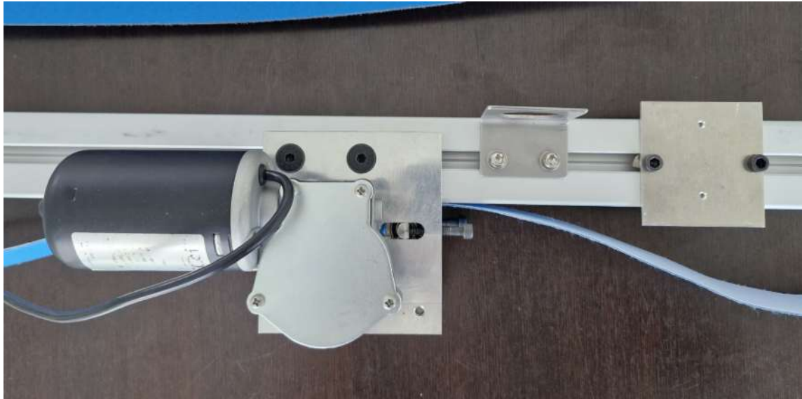
Figura 20. Col·locació del suport del pistó elevador.
