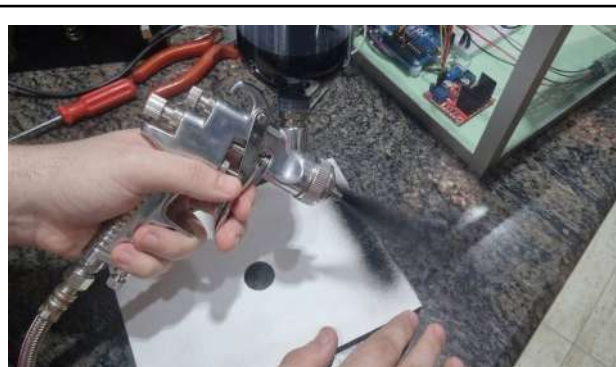
Fig. 80: Amb una pistola, lacat amb color negre de tota l'estructura.
