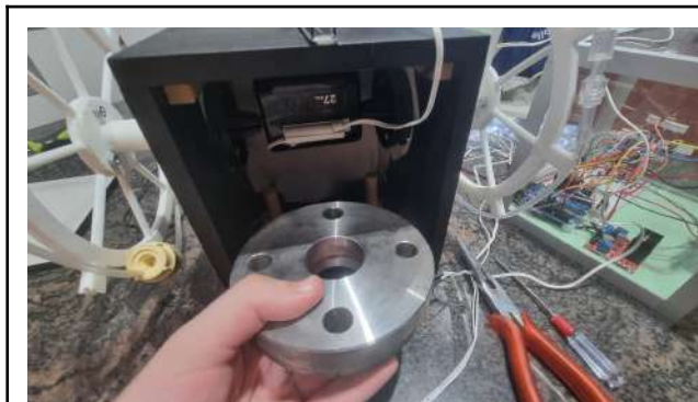
Fig. 79: Col·locació de les peses per evitar les vibracions generades amb el motor.
