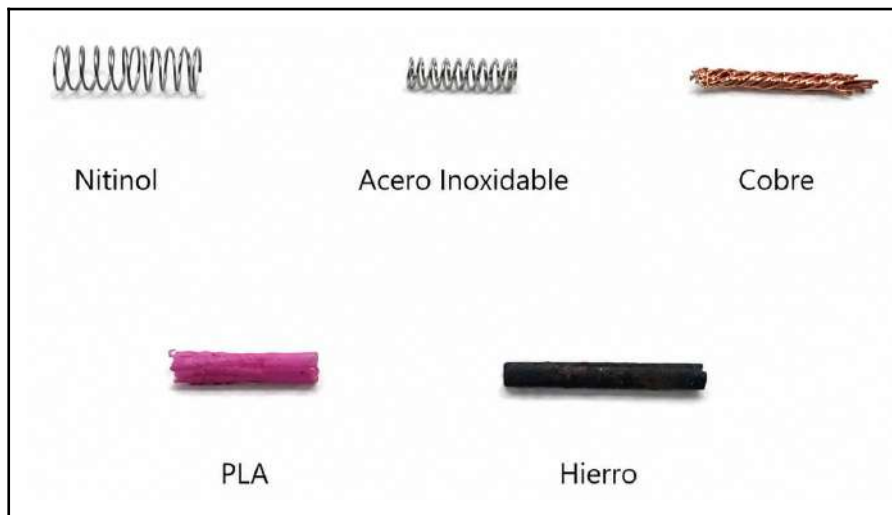
Fig. 142: Aspecte dels diferents stents utilitzats durant l'assaig experimental. Es pot observar una lleugera oxidació en el stent de ferro, mentre que la resta de materials no van presentar alteracions visibles.
