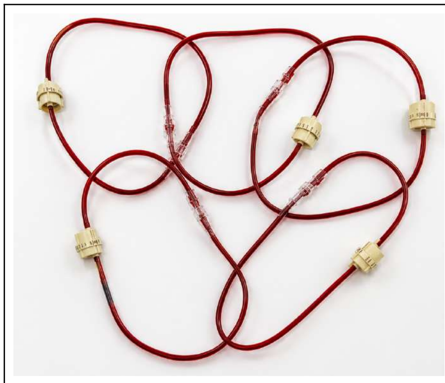
Fig. 144: Com van quedar tots els tubs amb els Stents i la sang després d'incubar i fer l'assaig d'hemocompatibilitat.
