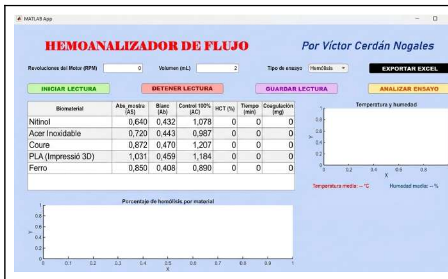
Fig. 145: Introducció de les dades obtingudes al Matlab després de la lectura amb l'espectrofotòmetre.
