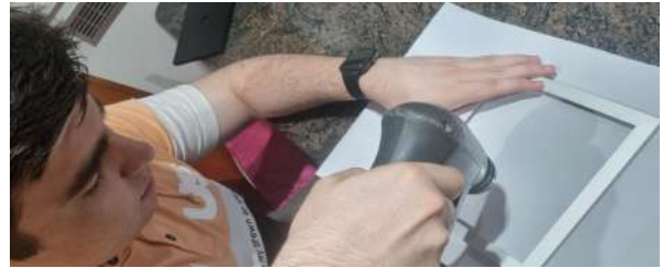
Fig. 86: Perforació de la placa de metacrilat per fer la botonera.
