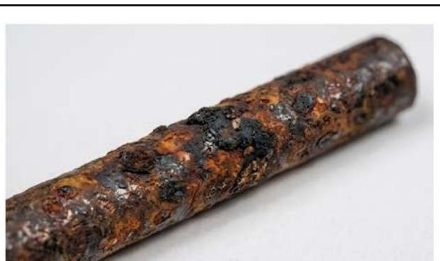
Fig. 147: Exterior del Stent simulat amb ferro, que mostra una oxidació per coàguls. Font: Pròpia
