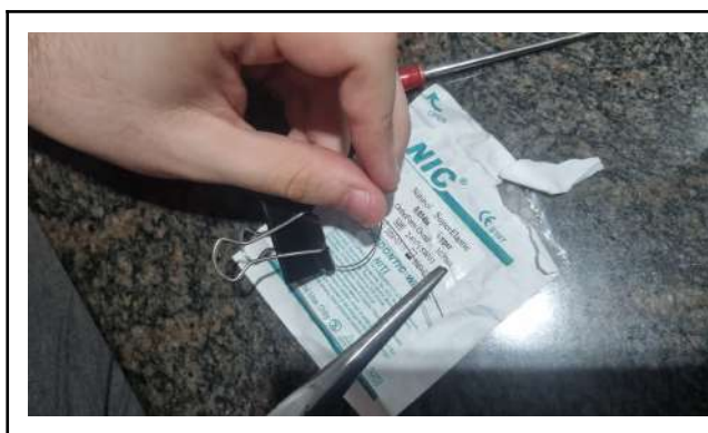
Fig. 110: Fixació del filament de Nitinol a un cargol amb pinces metàl·liques. Font: Pròpia
