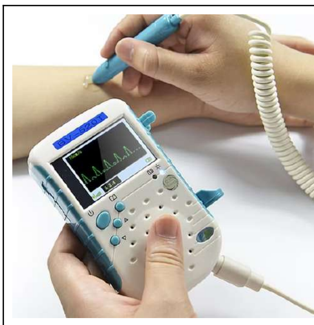
Fig. 155: Exemple de sensor de pressió i flux sanguini basat en ultrasons.
