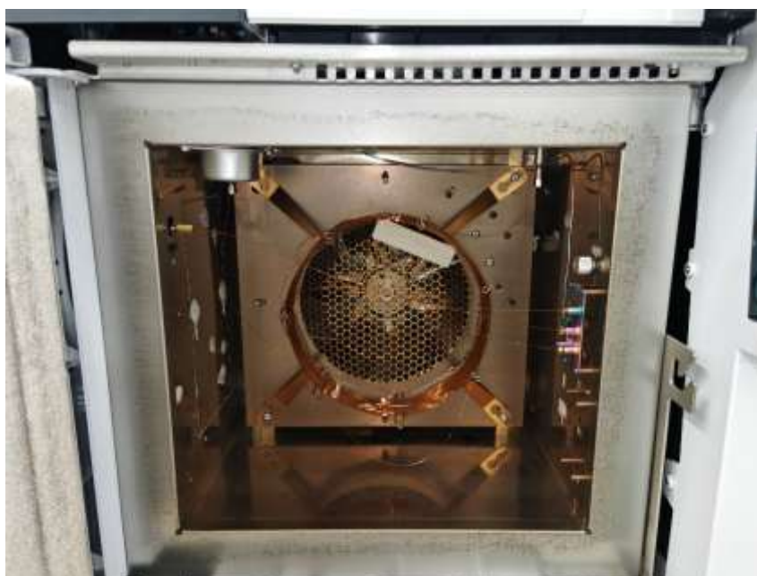
Il·lustració 7: Forn amb columna de cromatògraf de gasos. Font: Pròpia
