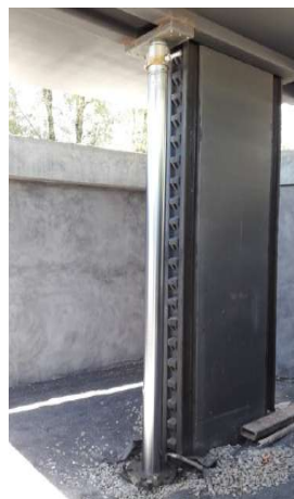
Figura 50. Sistema hidràulic d'impuls del mòdul mòbil
