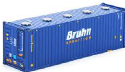
Figura 35. Contenedor de mercaderies a granel
