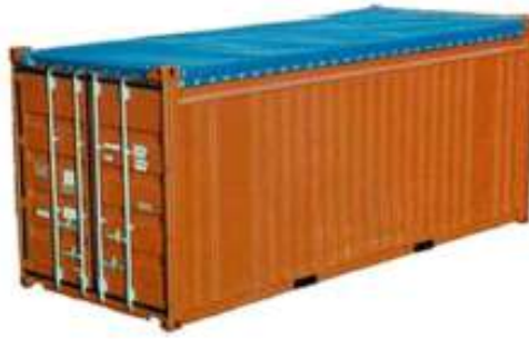
Figura 38. Contenedor Open Top
