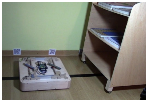
Figura 75. Comprovació del mecanisme de subjectió pel carro. Elaboració pròpia
