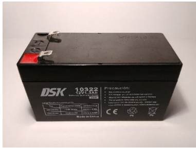
Figura 28. Bateria de la marca DSK de 12 Volts. Elaboració pròpia
