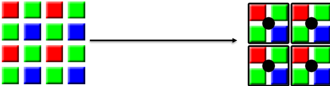
Figura 8. Representació filtre del sensor "Bayer Array". Font: https://www.cambridgeincolour.com/tutorials/camera-sensors.htm
