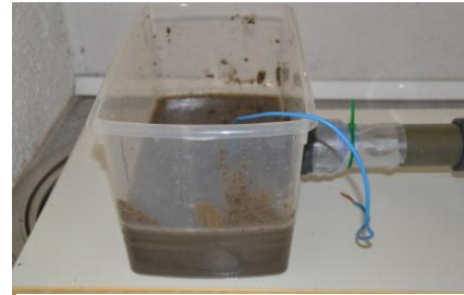
Imatge 28: Construcció de la cambra anòdica. Font : Pròpia
