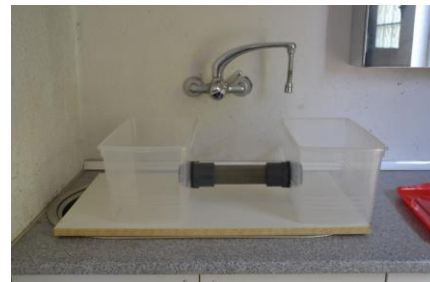
Imatge 23: Estructura de la MFC. Font: Pròpia
