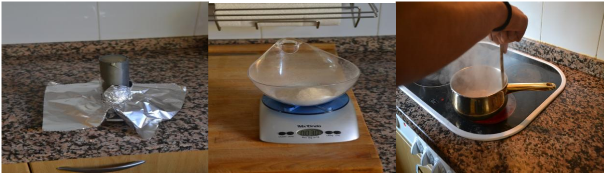
Imatge 25: Elaboració del pont salí. Font: Pròpia
