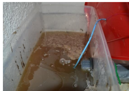
Imatge 6 Contingut fermentat del compartiment anòdic
