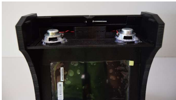
Subjecció dels altaveus amb cola calenta. Col·locació dels altaveus amb la seva peça a l'estructura.
