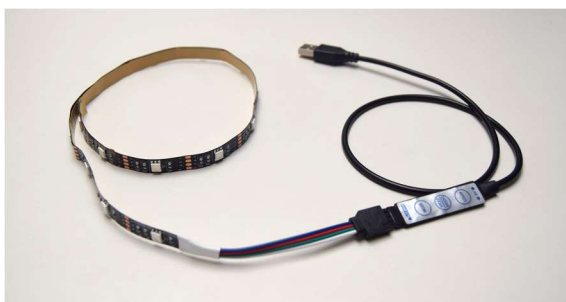
Tira LED amb placa controladora i cable USB.
