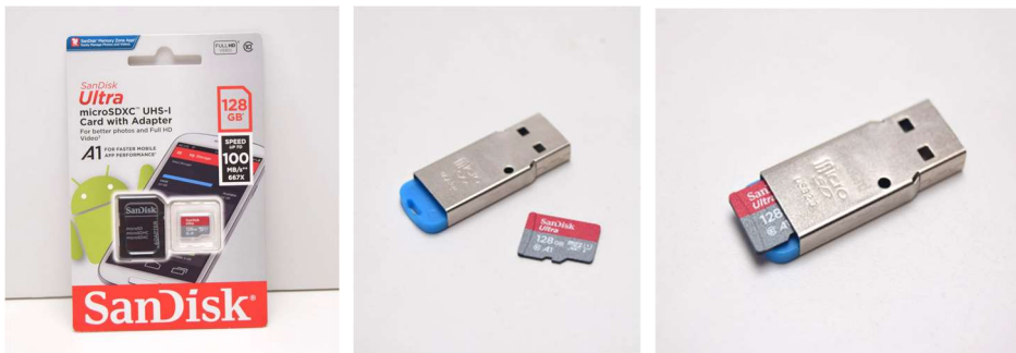
Targeta microSD de 128GB amb adaptador a USB.
