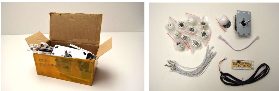
Kit amb botons, joystick, placa controladora i cables connectors.
