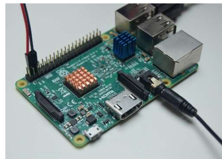
Connexió dels pins d'alimentació i el jack de 3.5mm.
