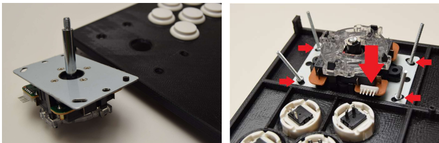
Instal·lació del joystick al panell central.
