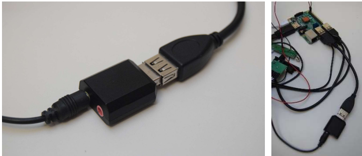
Connexió d'un adaptador de jack per USB.
