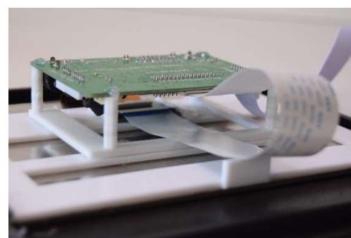
Connexió de cables CSI.
