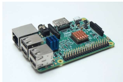
Dissipadors de calor pels xips de la Raspberry Pi.
