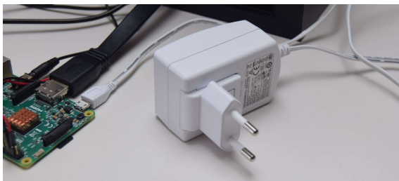
Connexió del cable d'alimentació microUSB.
