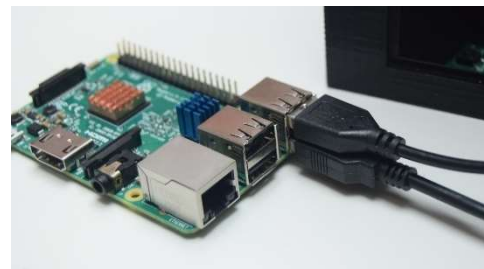
Connexió de cables USB a la Raspberry Pi.
