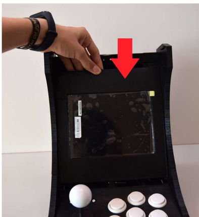
Col·locació de la pantalla al seu lloc, amb la peça pertinent entremig.
