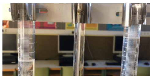
Figura 56: Relació 1:2 dels volums d'hidrogen, al tub de l'esquerra (12 mL), i d'oxigen, al tub de la dreta (6 mL).
