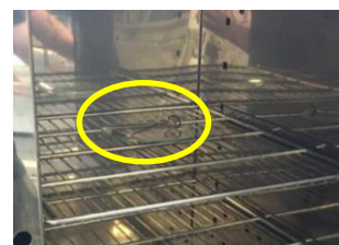
Figura 41: Encerclat en groc, el càtode sobre un vidre de rellotge dins el forn a més de 100°C.
