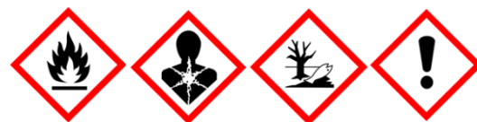
Figura 70. Pictogrames de seguretat del pentà: líquid inflamable, perillós per aspiració i pel medi ambient, i irritant.
