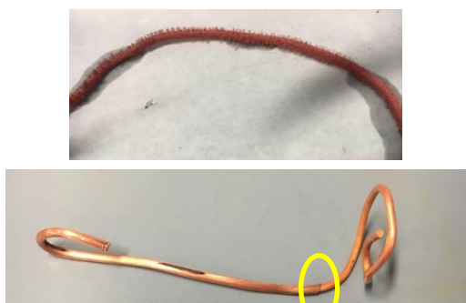
Figures 36 i 37: A dalt, es manifesta la deposició del coure a l'ànode. A baix, s'observa com el càtode ha perdut coure. Sobretot s'aprecia a la part marcada en groc, fins on l'elèctrode estava submergit.
