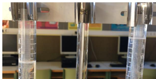
Figura 61: Relació 1:2 dels volums d'hidrogen, al tub de l'esquerra (12 mL), i d'oxigen, al tub de la dreta (6 mL).
