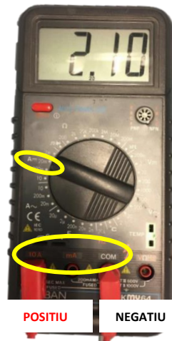
Figura 33: Aquesta és la manera com ha d'estar calibrat l'amperímetre. En groc, les dues funcions. Els noms positiu i negatiu corresponen als pols i com han d'estar connectats.
