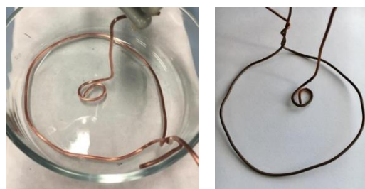
Figures 46 i 47: A l'esquerra, els elèctrodes abans de l'electròlisi. A la dreta, després del procés. El càtode a la dreta és més gruixut, i l'ànode més prim.
