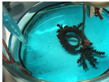
Figura 35: Pas 5, retirar la dissolució amb un comptagotes.
